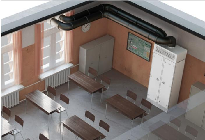
Aufstellung des CGL edu für eine schnelle Nachrüstung mit dem Kanalanschluss über ein Fenster. Die Lufteinbringung erfolgt über eine Ausblashaube mit Weitwurfdüsen. Das Gerät kann unkompliziert und ohne zusätzliche Dämmung durch ein ISO-Rohr-System (Zubehör) angebunden werden.
