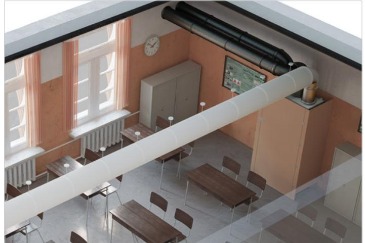
Nachrüstung des CGL edu mit einer Kernbohrung durch die Fassade. Einhausung des Gerätes zur Integration ins Raumbild und zur zusätzlichen Schallreduktion. Die Luftverteilung erfolgt über einen deckenhängenden Textilschlauch. Das Gerät kann einfach durch ein ISO-Rohr-System (Zubehör) angebunden werden.
